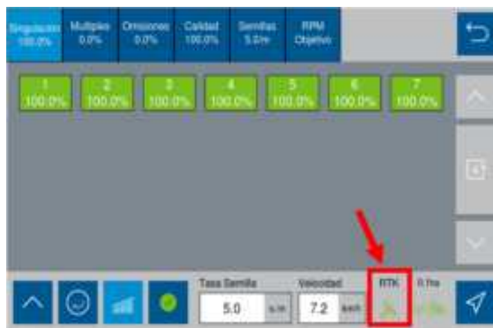
Figura 204 - Indicación del estado GPS
