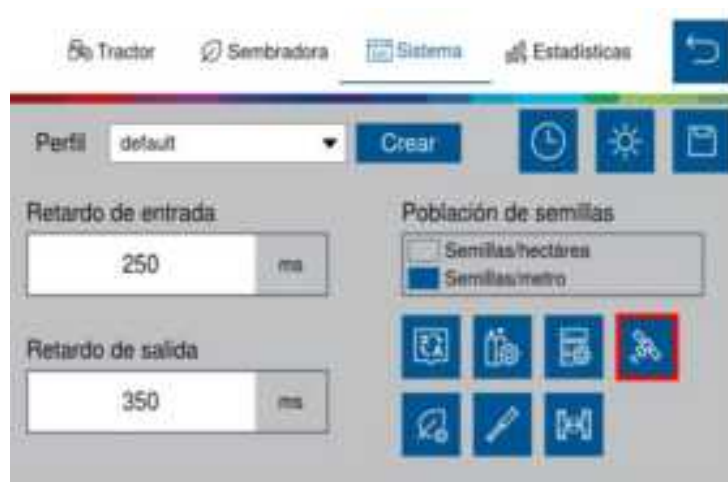
Figura 46 - Habilitar sensor de velocidad
