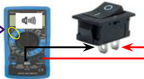
Figura 3 – Prueba del interruptor de encendido/apagado
