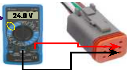
Figura 11 – Comprobación de la tensión del motor
