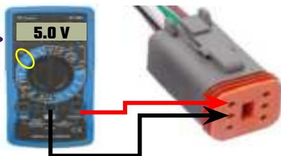
Figura 9 – Comprobación de la tensión del sensor de rotación
