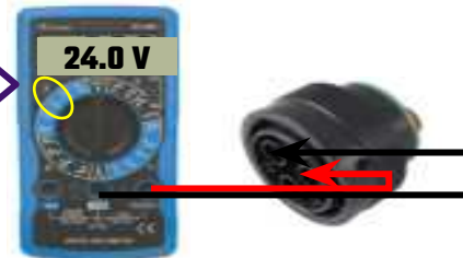
Figura 5 – Verificando carga de la Powerbox
